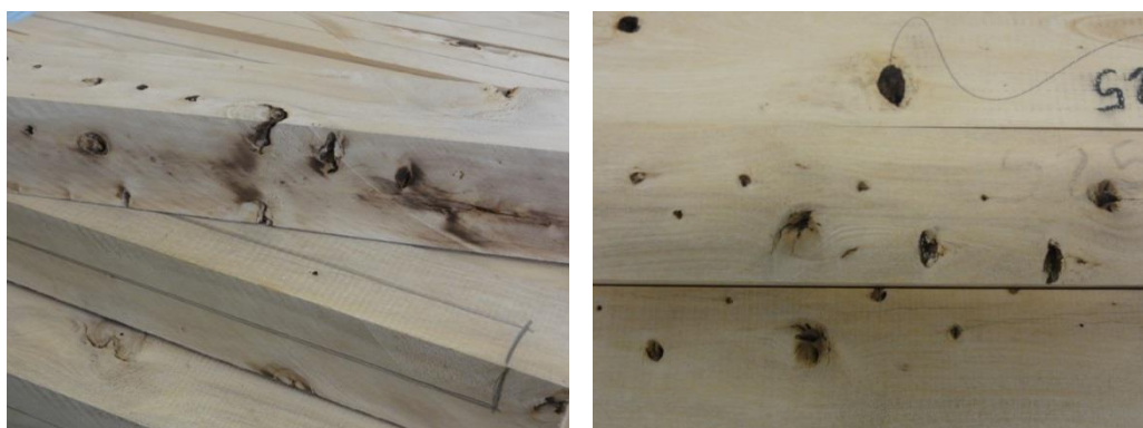
Figura 4. Presencia de numerosos nudos, como el defecto más relevante aun en la madera de las trozas A y B de los árboles seleccionados.
