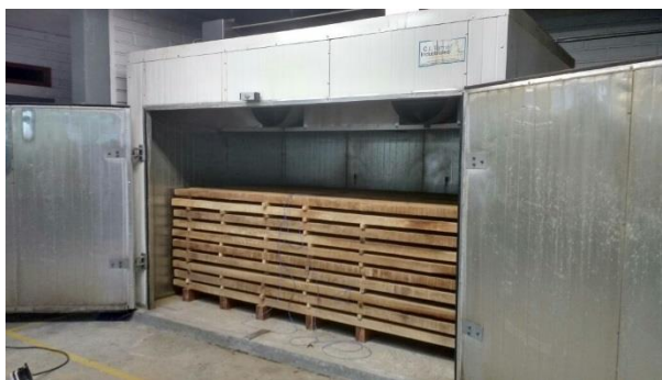
Figura 2. Tablones en horno de secado para agilizar la pérdida de humedad en la madera.
